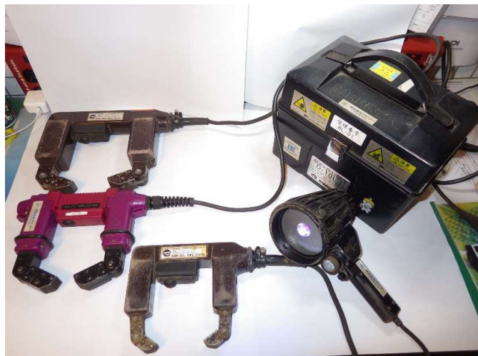
携帯型極間式磁化器と紫外線照射灯
