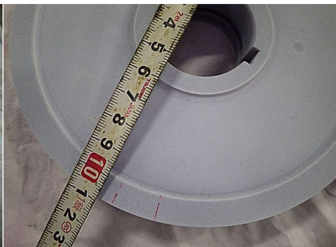
現像処理・観察（割れによる浸透指示模様あり）
